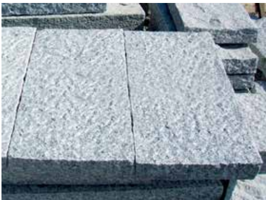
Figur 6.5 Råhogde plater med satte, definerte kantlinjer (foto: René Kierstein)
