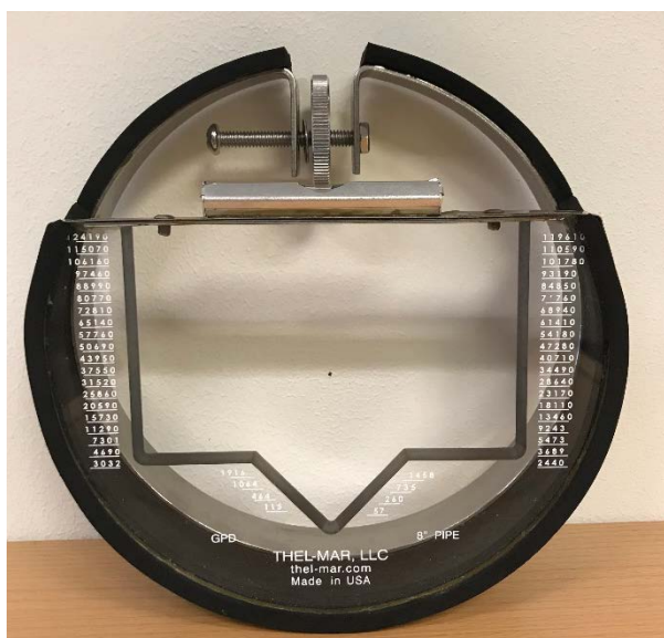
Figur 11 V-profil 200 mm for å kontrollere avrenning (Foto: Edvard Sivertsen).
