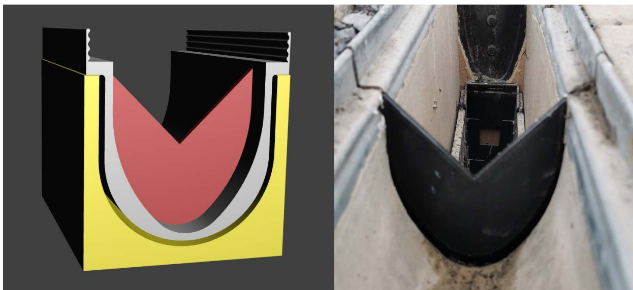
Figur 13 V-profil plassert i ACO-renne for å måle avrenning av felt 6, tegning for 3D-printing (venstre) og ferdig løsning (høyre) (Tegning og foto: Terje Gaarden).
