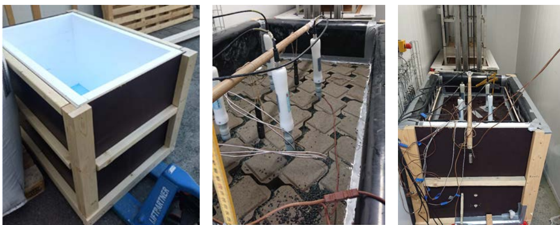
Figur 39 Laboratorieoppsett permeable dekker. (Foto: Heidi Jensen)
