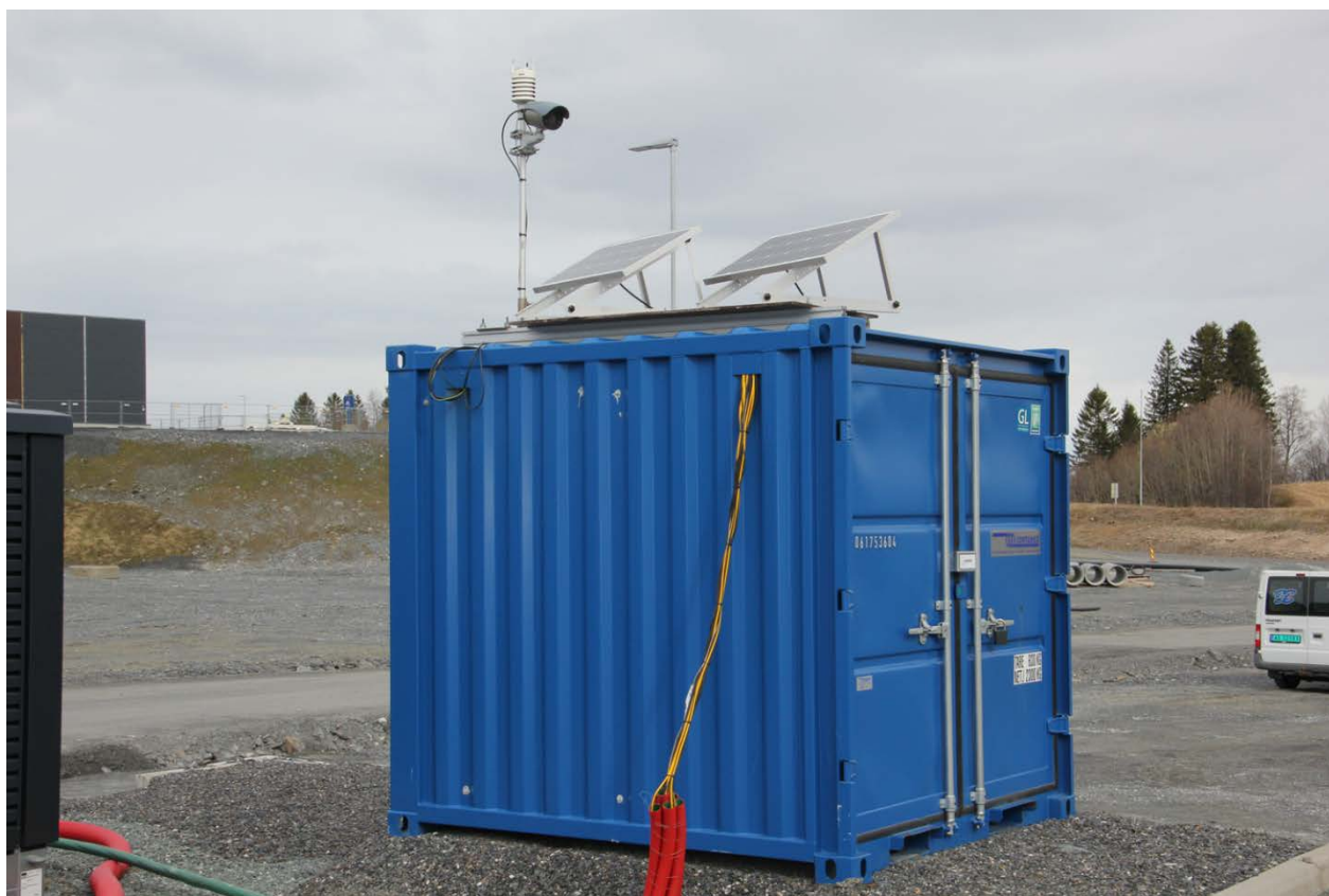
Figur 9 Mobil feltstasjon med værstasjon, kamera, dataloggere og dataoverføringsenheter (Foto: Terje Gaarden).
